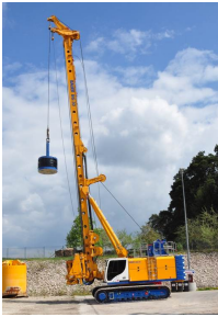
Abb. 7.2.: Ein Bohrergerät bei Durchführung des Prüfzyklus „Windentest“ (links), Quelle: BAUER Maschinen GmbH; Aus der Seilkennlinie abgewandeltes Prüfzyklenprogramm „Kellybohren“ (rechts)
