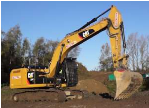
Abbildung 6-6: Kettenbagger CAT 324E
