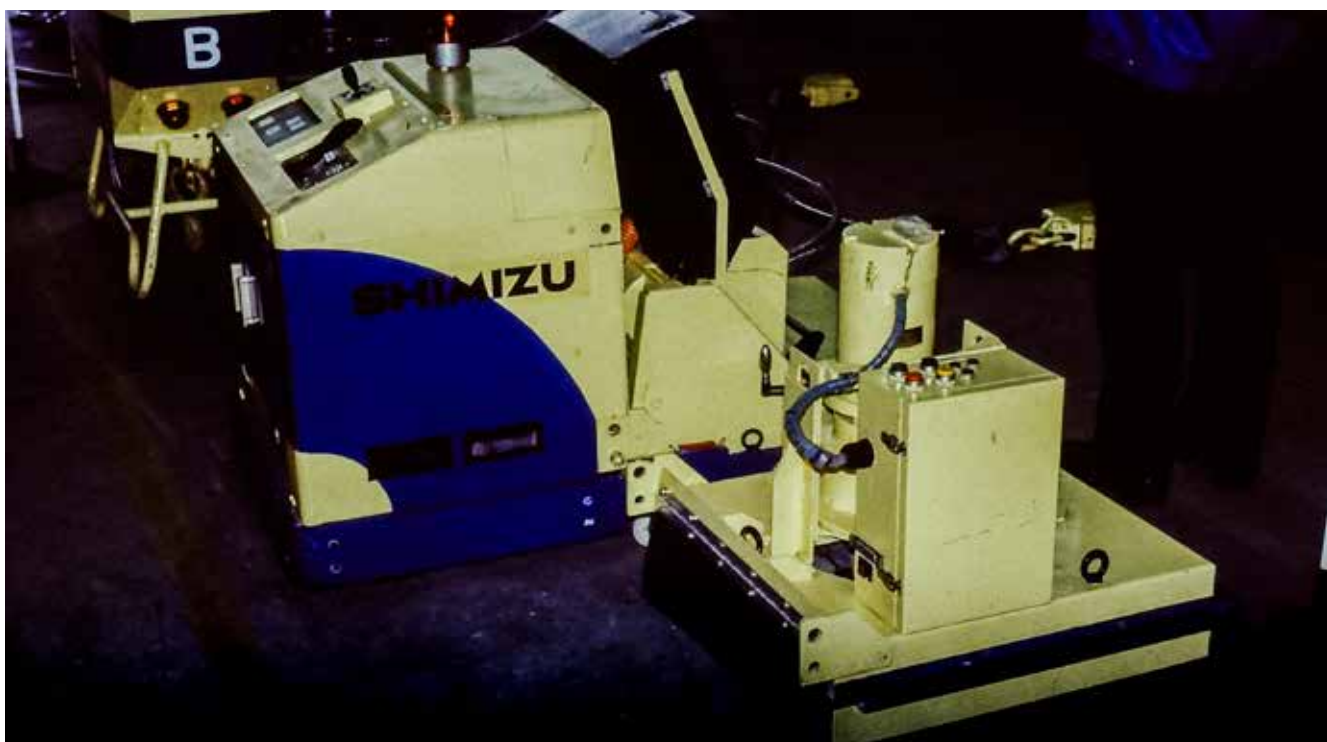
MTV Multipurpose Travail Vehicle von der Baufirma Shimizu Construction, Tokio: Der erste modulare Bau-Roboter kommt schon 1978 zum Einsatz.
